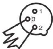
Le bouchon de terminaison réduit les erreurs de signal et évite les problèmes de transmission de signal et les interférences. Il est toujours recommandé de connecter un bouchon DMX (résistance 120 Ohm  $\frac{1}{4}$  W) entre la broche 2 (DMX-) et la broche 3 (DMX+) de la dernière unité.
